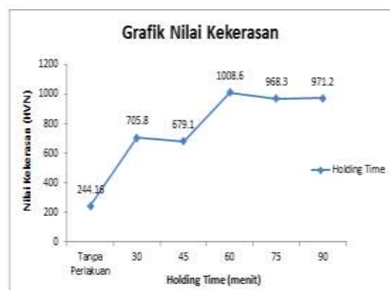
Gambar 4 Grafik Uji Nilai Kekerasan (HVN)
