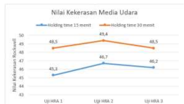
Gambar 4.3 Grafik nilai kekerasan pada media pendingin udara
