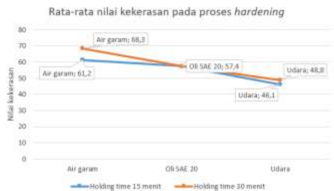
Gambar 4.4 Grafik nilai rata-rata kekerasan pada proses hardening dengan media pendingin air garam, oli SAE 20 serta udara.
