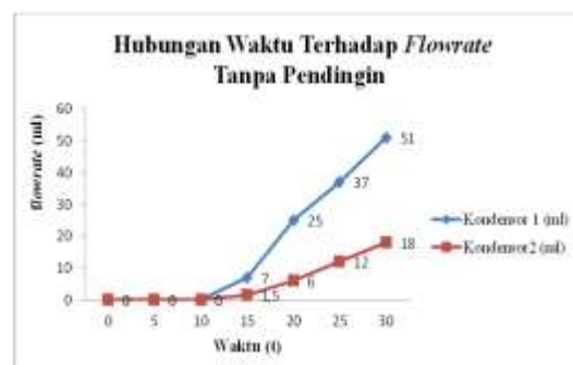
Gambar 4. garfik suhu Terhadap Flowrate Dengan Waktu 30 Menit Tanpa Pendingin
