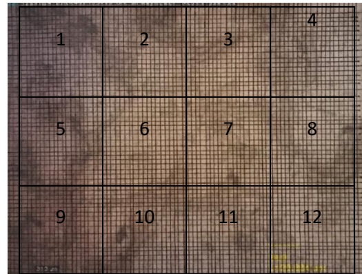
Gambar 3. Foto struktur mikro Al-Mg 2% pendinginan 0°C
