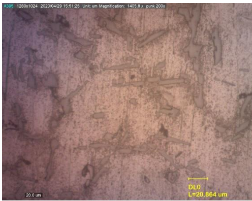
Gambar 2. Foto struktur mikro Al-Mg 2% pendinginan 0°C
