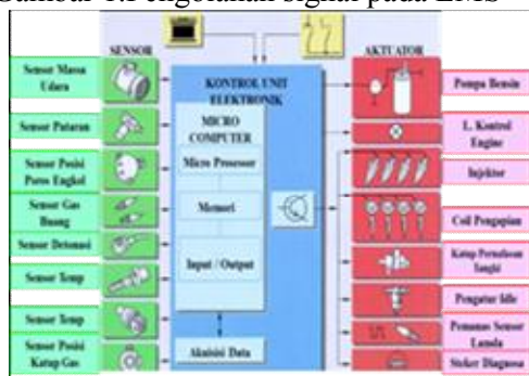
Gambar 1. Pengolahan signal pada EMS
