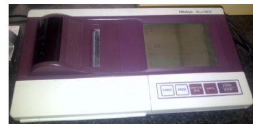
Surf Test Mitutoyo SJ-301 ( Sumber: Document Pribadi)
