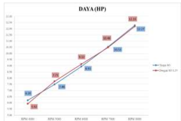
Gambar 4 Grafik perbandingan daya terhadap speedspark open looper dengan setingan 0,1V
