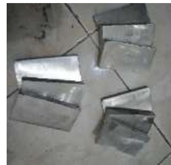
Gambar 3. Spesimen uji kekerasan
