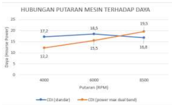
Gambar 4.3 Grafik Hubungan Putaran Mesin Terhadap Daya
