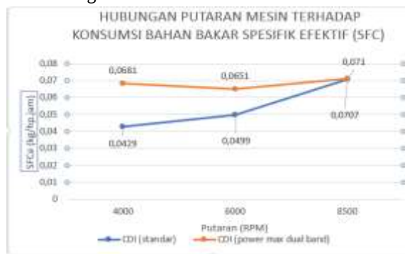
Gambar 4.4 grafik hubungan putaran mesin terhadap konsumsi bahan bakar
