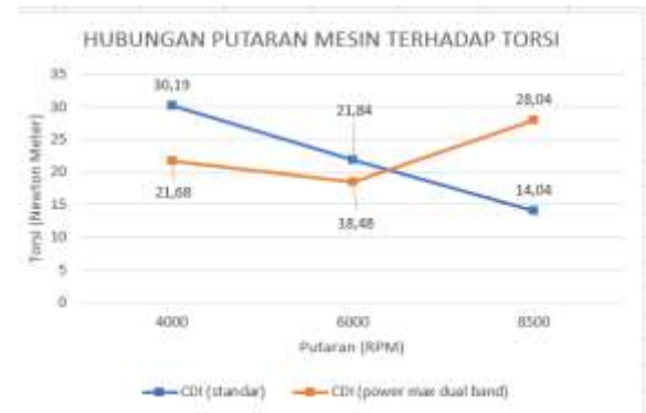
Gambar 4.2 Grafik Hubungan Putaran mesin Terhadap Torsi
