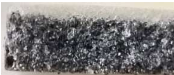
Hasil uji tarik dengan valume serbuk besi 30%
