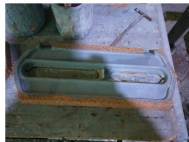
Gambar 3. Hasil Pembuatan inti Menggunakan Daur Ulang Pasir Silika
