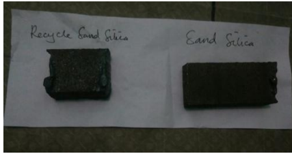
Gambar 4. Hasil Cor Baja Menggunakan Pasir Silika dan Daur Ulang Pasir Silika
