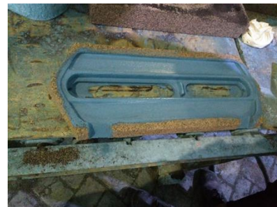
Gambar 2. Hasil Pembuatan Inti Menggunakan Pasir Silika
