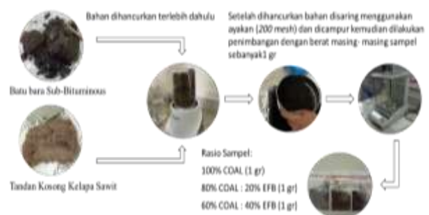
Gambar 1. Skema Instalasi Proses Pencampuran
