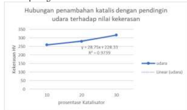
Gambar 2. Pengaruh penambahan katalis 10, 20, 30% dan media pendingin udara pada hasil kekerasan.
