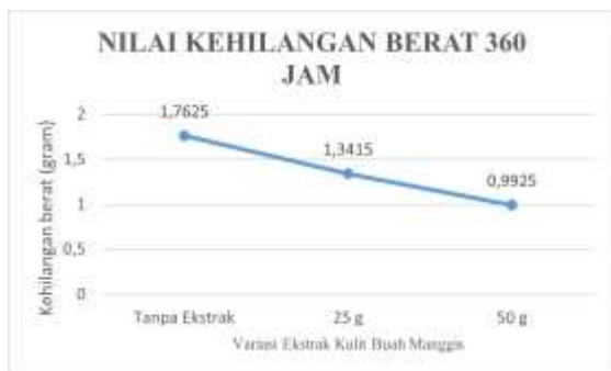
Gambar 6 Grafik Pengaruh Kehilangan Berat pada 360 jam
