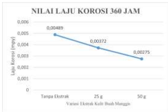
Gambar 5 Grafik Pengaruh Laju Korosi pada 360 jam
