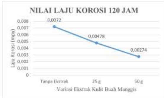
Gambar 1 Grafik Pengaruh Laju Korosi pada 120 jam.
