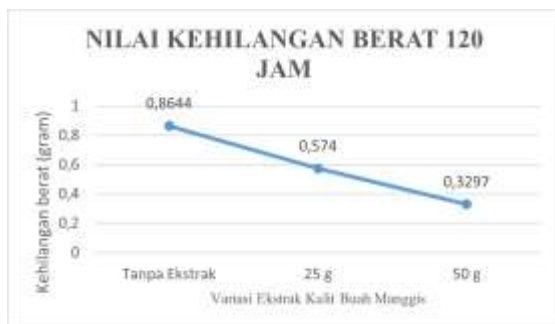
Gambar 2 Grafik Pengaruh Laju Korosi pada 120 jam.
