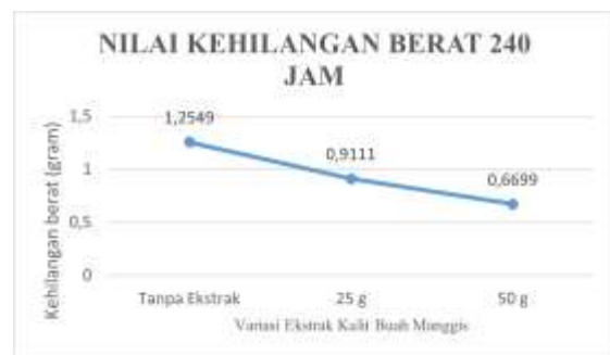
Gambar 4 Grafik Pengaruh Kehilangan Berat pada 240 jam.
