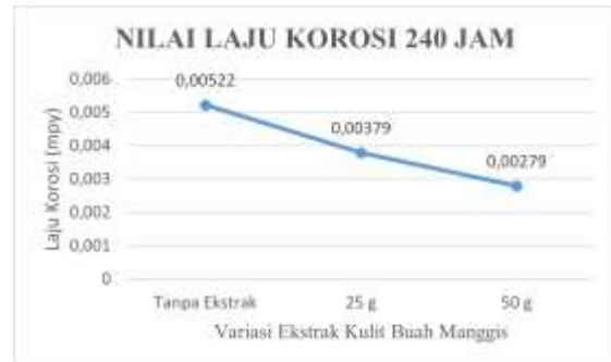
Gambar 3 Grafik Pengaruh Laju Korosi pada 240 jam.
