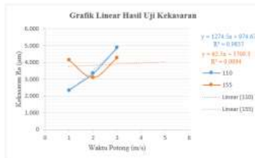
Diagram 4. 6 Grafik Scatter Kekasaran Kecepatan Spindel 110 dan 155 Rpm Variasi Waktu 5, 10, 15 Menit
