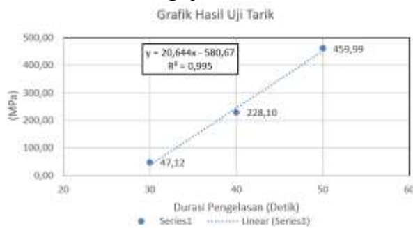
Gambar 2. Grafik nilai uji tarik & regresi linier (Sumber: Hasil Perhitungan, 2025)
