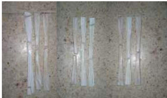
Gambar 3. Hasil Uji tarik orientasi serat anyaman
