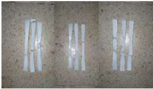
Gambar 2. Hasil Uji tarik orientasi serat lurus
