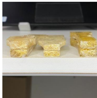
Hasi Uji Spesimen NaOH 5% Arah Serat Acak
