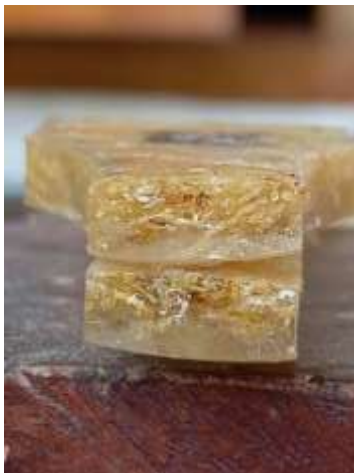
Gambar 8. Foto hasil uji tarik orientasi acak konsentrasi NaOH 7%
