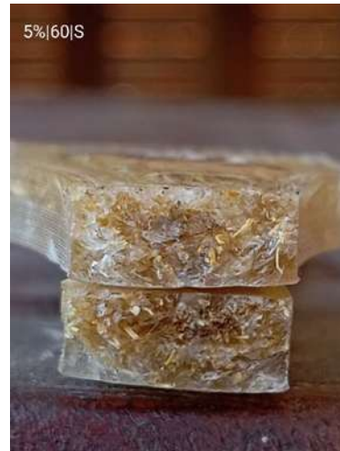
Gambar 5. Foto hasil uji tarik orientasi sejajar konsentrasi NaOH 5%.
