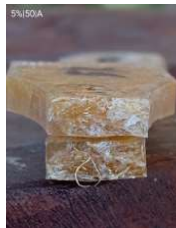
Gambar 6. Foto hasil uji tarik orientasi acak konsentrasi NaOH 5%
