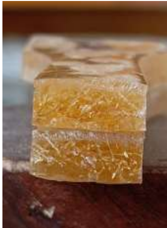
Gambar 7. Foto hasil uji tarik orientasi sejajar konsentrasi NaOH 7%
