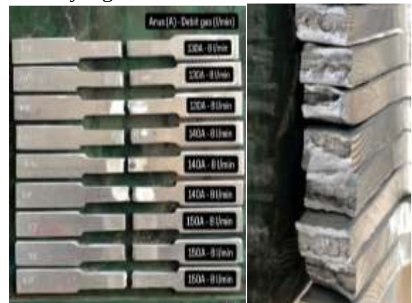
Gambar 4. 2 Gambar patahan melintang sambungan Debit Gas 8 l/m.
