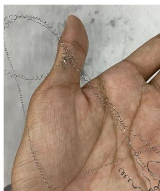
Gambar 4. hasil geram dengan putaran spindel 900 rpm
