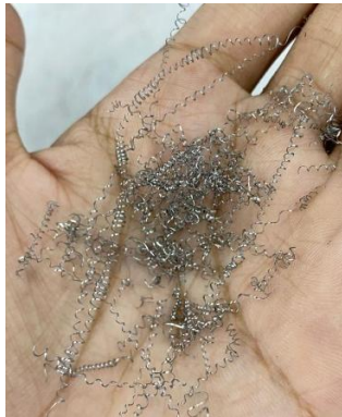
Gambar 3. hasil geram dengan putaran spindel 700 rpm
