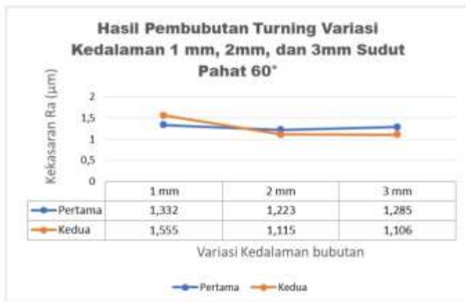
Gambar 4. 1 Hasil Pembubutan Turning Variasi Kedalaman 1 mm, 2mm,dan 3mm Sudut Pahat 60°
