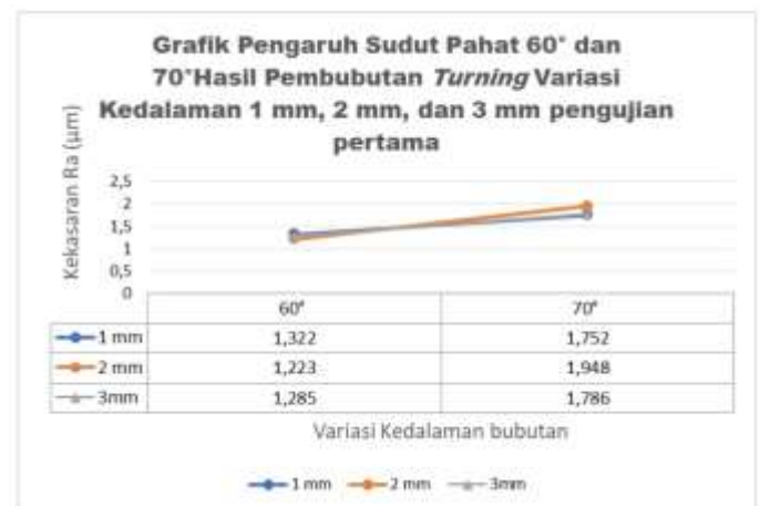
Gambar 4. 5 Pengaruh Sudut Pahat 60° dan 70° Hasil Pembubutan Turning Variasi Kedalaman 1 mm, 2 mm, dan 3 mm pengujian pertama
