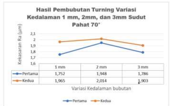
Gambar 4. 2 Hasil Pembubutan Turning Variasi Kedalaman 1 mm, 2mm, dan 3mm Sudut Pahat 70°
