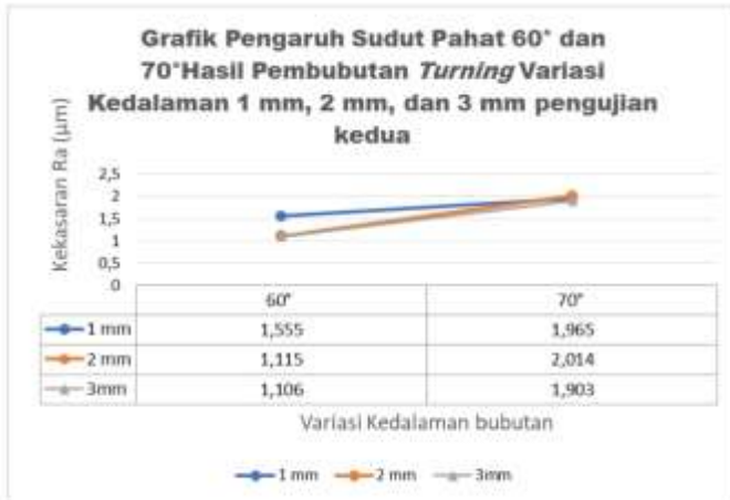
Gambar 4. 6 Pengaruh Sudut Pahat 60° dan 70° Hasil Pembubutan Turning Variasi Kedalaman 1 mm, 2 mm, dan 3 mm pengujian kedua (Sumber : Dokumen Pribadi)
