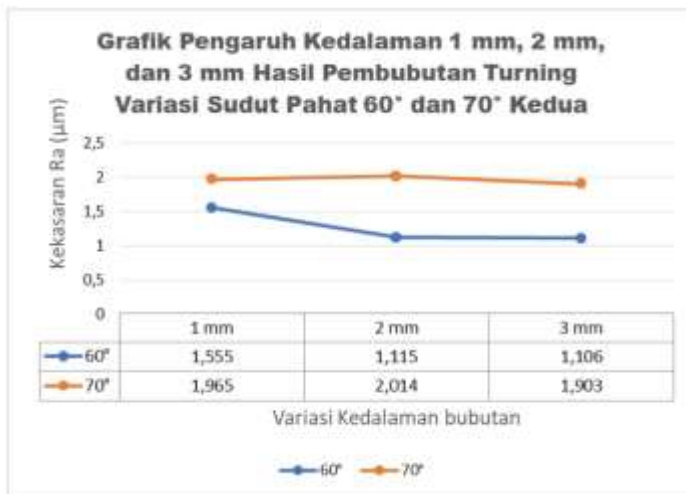
Gambar 4. 4 Pengaruh Kedalaman 1 mm, 2 mm, dan 3 mm Hasil Pembubutan Turning Variasi Sudut Pahat 60° dan 70° pengujian kedua
