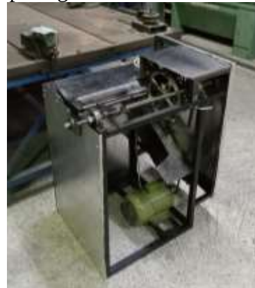
Gambar 7. Hasil Jadi Mesin Perajang Kerupuk Pokcoy
