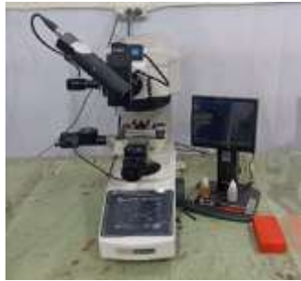
Gambar 3.22 Alat Uji Kekerasan Vickers
