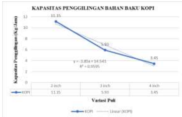
Grafik pengaruh variasi puli terhadap kapasitas penggilingan pada bahan baku kopi
