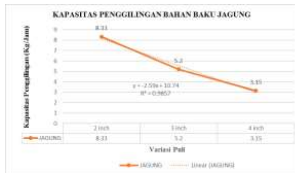
Grafik pengaruh variasi puli terhadap kapasitas penggilingan pada bahan baku jagung.
