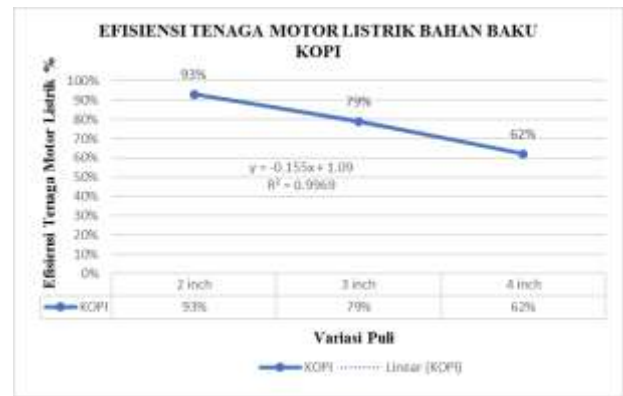
Grafik pengaruh variasi puli terhadap efisiensi tenaga motor listrik pada bahan baku kopi
