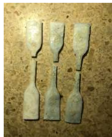
gambar 4. Foto hasil uji tarik konsentrasi NaOH 5%
