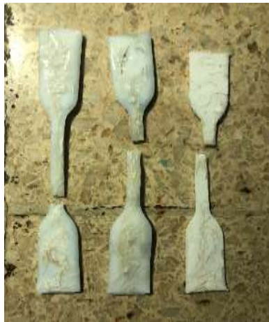
Gambar 5. Foto hasil uji tarik konsentrasi NaOH 10%
