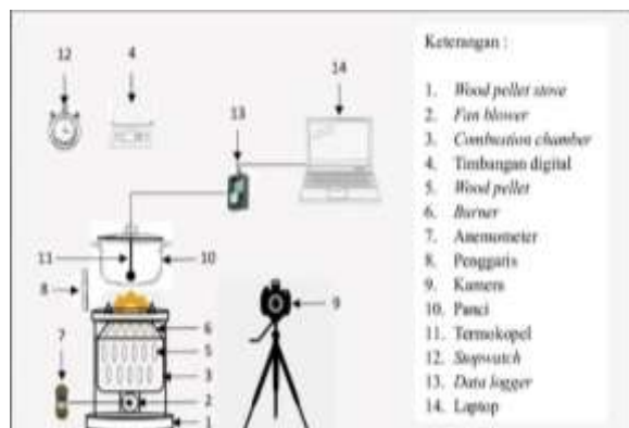
Gambar 1. Instalasi pengujian WBT + visualisasi nyala api
