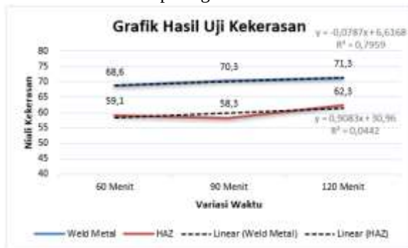
Gambar 2. Grafik Hasil Uji Kekerasan
