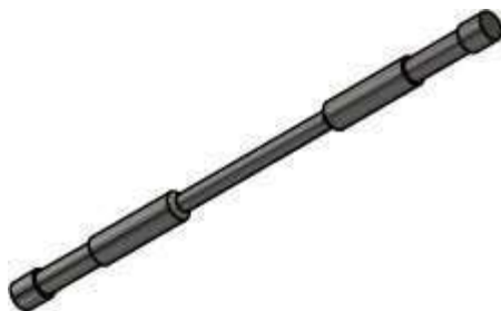
Gambar 2. Model Spesimen Baja Karbon Rendah
