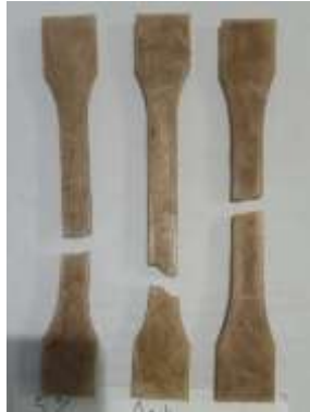
Gambar 6 Foto hasil uji tarik serat serah
