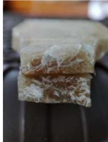
Gambar 9. Foto hasil uji tarik orientasi acak 50%
