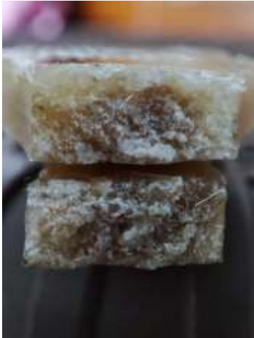
Gambar 7. Foto hasil uji tarik orientasi searah 60%
