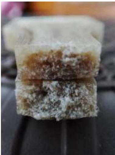
Gambar 8. Foto hasil uji tarik orientasi searah 70%
