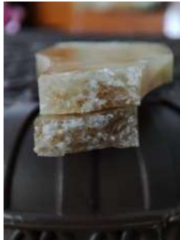
Gambar 10. Foto hasil uji tarik orientasi acak 60%
