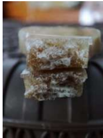
Gambar 10. Foto hasil uji tarik orientasi acak 60%
