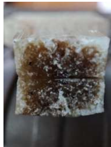
Gambar 6. Foto hasil uji tarik orientasi searah 50%
