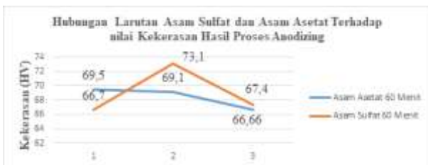
Gambar 8. Grafik Hubungan Larutan Asam Asetat dan Sulfat waktu 60 Menit pada Sealing Terhadap Nilai Kekerasan Hasil Proses Anodizing
