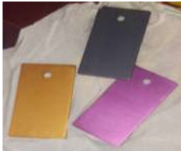
Gambar 2. Hasil Spesimen Setelah dilakukan proses Anodizing
