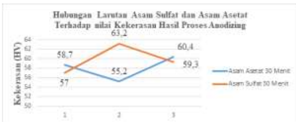
Gambar 7. Grafik Hubungan Larutan Asam Asetat dan Sulfat waktu 30 Menit pada Sealing Terhadap Nilai Kekerasan Hasil Proses Anodizing
