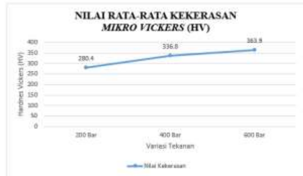
Gambar . Grafik uji kekerasan logam (sumber : Dokumen pribadi)
