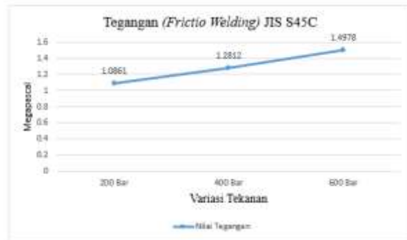
Gambar 1. Grafik tegangan sambungan las gesek (sumber : Dokumen pribadi)
