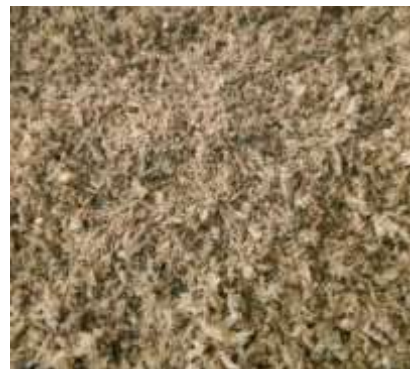
Gambar 2. Output hasil ikan tongkol oleh mesin penyuir bentuk pisau V
