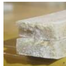
Gambar 10. Spesimen 16g ME; 3,4g SCT; 0,6g SAT 100 mesh
