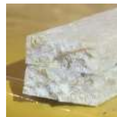
Gambar 9. Spesimen 14g ME; 5,6g SCT; 0,4g SAT 100 mesh
