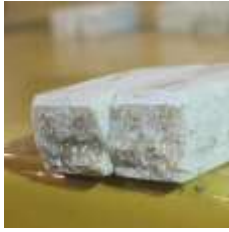
Gambar 20. Spesimen 7g ME; 2,8g SCT; 0,2g SAT; 100 mesh (Sumber: Dokumentasi pribadi)
