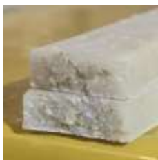
Gambar 7. Spesimen 16g ME; 3,4g SCT; 0,6g SAT 120 mesh
