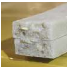
Gambar 6. Spesimen 14g ME; 5,6g SCT; 0,4g SAT 120 mesh
