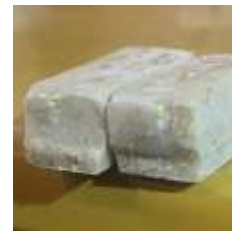
Gambar 18. Spesimen 8g ME; 1,7g SCT; 0,3g SAT 120 mesh (Sumber: Dokumentasi pribadi)
