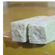
Gambar 19. Spesimen 6g ME; 3,9g SCT; 0,1g SAT; 100 mesh (Sumber: Dokumentasi pribadi)
