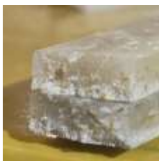
Gambar 13. Spesimen 16g ME; 3,4g SCT; 0,6g SAT 80 mesh (Sumber: Dokumentasi pribadi)
