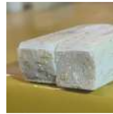
Gambar 17. Spesimen 7g ME; 2,8g SCT; 0,2g SAT; 120 mesh (Sumber: Dokumentasi pribadi)
