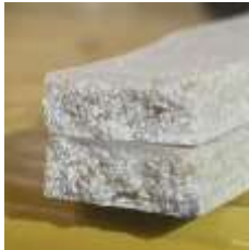
Gambar 11. Spesimen 12g ME; 7,8gSCT; 0,2g SAT 80 mesh (Sumber: Dokumentasi pribadi)
