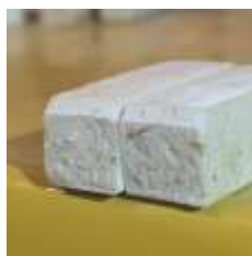
Gambar 16. Spesimen 6g ME; 3,9g SCT; 0,1g SAT; 120 mesh (Sumber: Dokumentasi pribadi)
