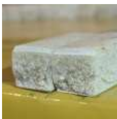
Gambar 23. Spesimen 7g ME; 2,8g SCT; 0,2g SAT; 80 mesh (Sumber: Dokumentasi pribadi)
