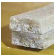
Gambar 12. Spesimen 14g ME; 5,6g SCT; 0,4g SAT 80 mesh (Sumber: Dokumentasi pribadi)
