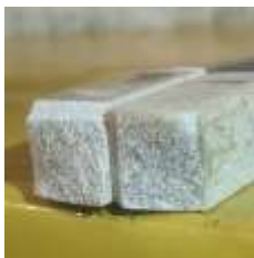
Gambar 22. Spesimen 6g ME; 3,9g SCT; 0,1g SAT; 80 mesh (Sumber: Dokumentasi pribadi)
