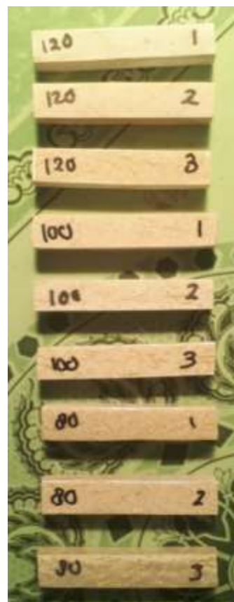
Gambar 14. Benda uji untuk uji impak (Sumber: Dokumentasi pribadi)
