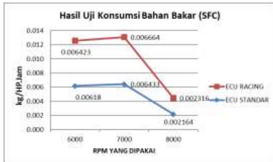
Gambar 8. Hubungan putaran terhadap konsumsi bahan bakar spesifik
