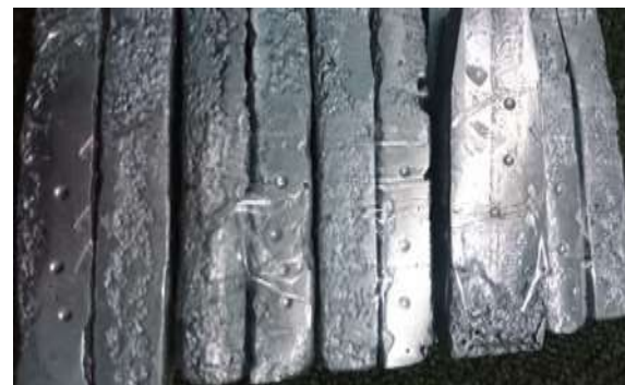
Gambar 4.1 Hasil Uji Kekerasan Brinell
