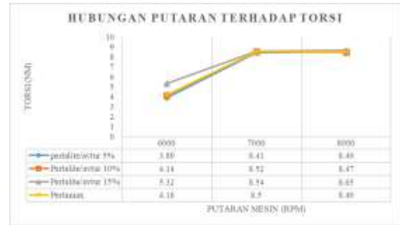
Gambar 5. Hubungan putaran terhadap torsi
