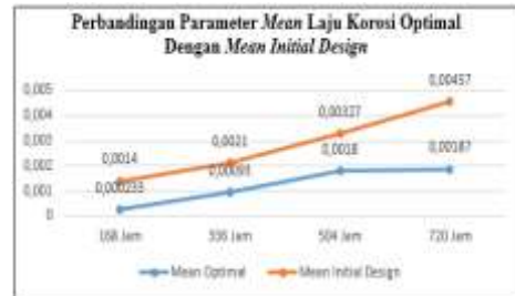
Gambar 11 Robust Design Laju Korosi Pada Parameter Optimal (Sumber : Grafik Data Pribadi)
