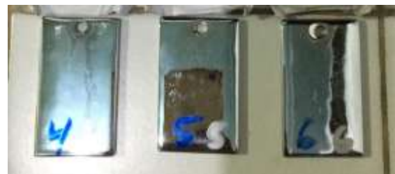
Gambar 3.3 Hasil Elektroplating Waktu 90 menit
