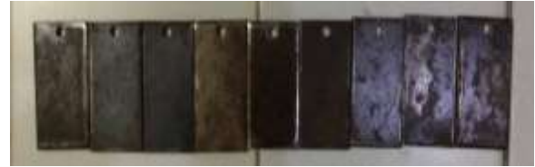
Gambar 3. 1 Potongan Baja ST37 Sebelum dilapisi
