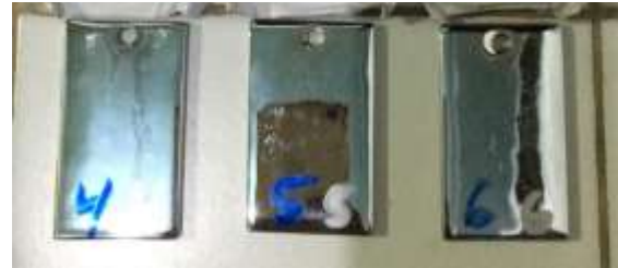
Gambar 3.2 Hasil Elektroplating Waktu 45 menit
