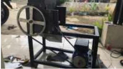
Gambar 3. 2 Mesin penggiling limbah kaca dengan sistem transmisi pulley
