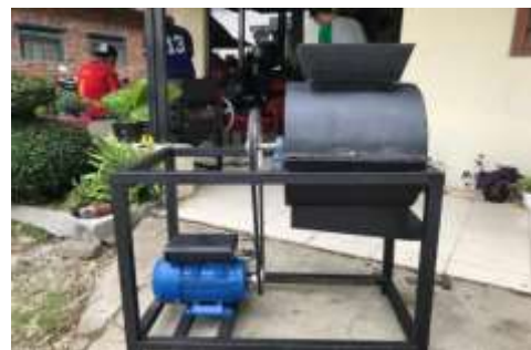
Gambar 4.8 Mesin Penghancur LimbahKaca Kapasitas 60Kg/jam (Sumber : Dokumen Pribadi)
