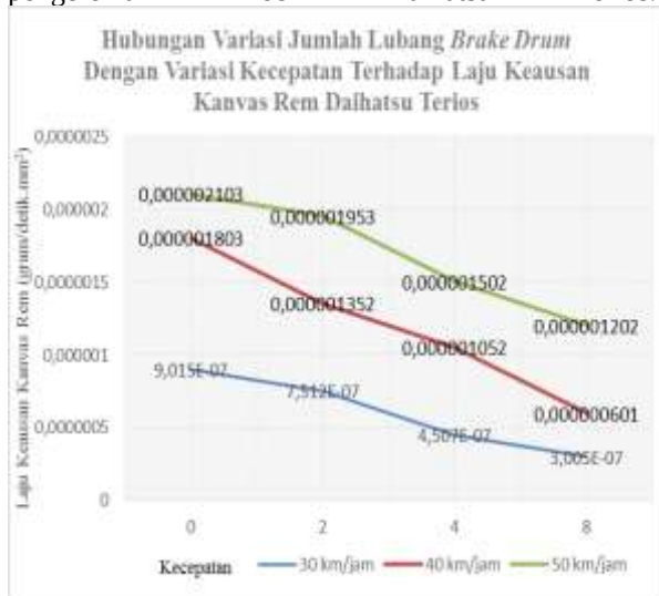
Grafik 2. Hubungan Variasi Jumlah Lubang Brake Drum Dengan Variasi Kecepatan Terhadap Laju Keausan Kanvas Rem
