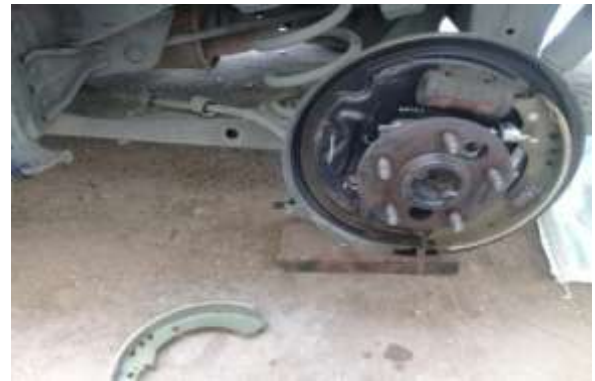
Gambar 2. Pemasangan Kanvas Rem
