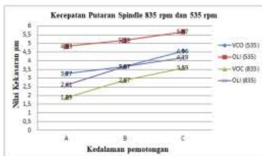
Gambar 4.3 Grafik hubungan variasi kedalaman pemotongan dan media pendingin terhadap rata-rata nilai kekasaran dengan kecepatan putaran spindle 835 Rpm dan 535 Rpm pada proses turning baja ST 42.
