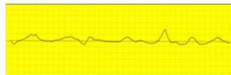
Gambar 4.7 Grafik Kekasaran Pengecoran Alumunium Pada Pasir Kali
