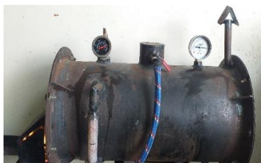
Gambar 3.1 Pengujian Boiler Pipa Api (Sumber : Hasil Pengujian)
