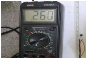
Gambar 3.2. Pengujian sensor suhu LM35 menggunakan termometer (Sumber: Pengujian)
