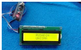
Gambar 4.8 Hasil Pengujian LCD 16x2 i2c
