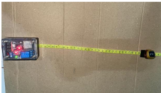
Gambar 6 pengukuran jarak deteksi UUID Bluetooth 30Cm
