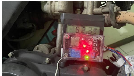
Gambar 8 pengujian suhu modul di dekat blok mesin
