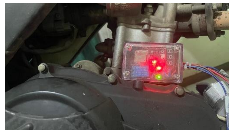
Gambar 7 pengujian getaran saat mesin motor idle
