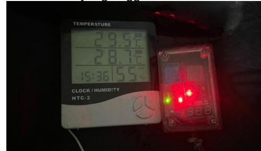
Gambar 9 pengujian kelembaban di dalam jok Motor
