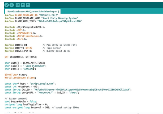
Gambar 7. Pemrograman Inisialisasi Variabel di Arduino IDE
